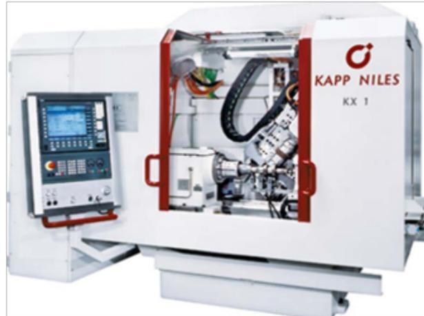
蜗杆磨齿机的待加工齿轮齿面余量通过蜗轮与待加工齿轮之间的啮合传动进行磨削，具有加工效率高、加工性能稳定、产品质量高等优点，普遍应用于中小型齿轮的精加工。目前，蜗杆磨齿机的研究主要有这几个方面：1. 基于蜗杆磨齿机各轴的运动特点，从数控系统对蜗杆磨齿机各轴的误差进行补偿，从而提高齿轮的齿向、齿距、齿形等几何精度；2. 采用某种径向热误差补偿方法，降低机床热误差对齿轮M值(即档距，它是反映齿轮分度圆齿厚的一个测量指标)的影响，提高齿轮的齿厚精度和运动精度。蜗杆磨齿机的原理与滚齿机类似□KAPP NILES磨齿机多少钱
